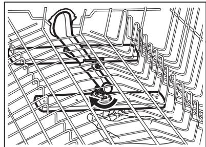
3. Промойте разбрызгиватель под струей воды. Для прочистки отверстий от частиц грязи воспользуйтесь заостренным предметом (например, зубочисткой).
