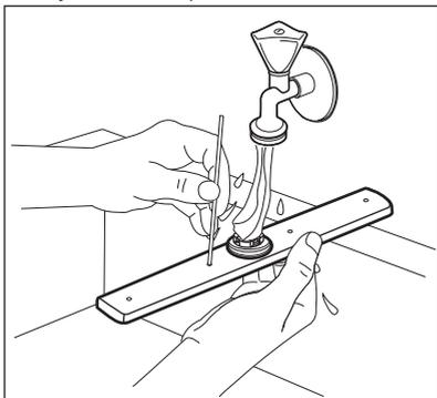
4. Для установки разбрызгивателя на место установите фиксатор в место установки разбрызгивателя и закрепите его на трубе подачи воды, повернув против часовой стрелки. Убедитесь, что фиксатор защелкнулся.
