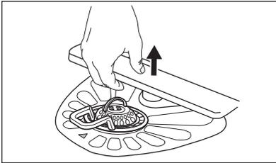
2. Промойте разбрызгиватель под струей воды. Для удаления частиц грязи из отверстий воспользуйтесь тонким острым предметом, например, зубочисткой.
