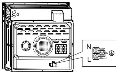
Духовой шкаф предназначен для работы в сети 220-240 В ~50 Гц, полная мощность нагрузки 3000 Вт. Кабель, используемый для прямого подключения к электросети должен быть с сечением 1,5 мм, с двухполюрным выключателем с минимальным значением 250В, 20А. Желто-зеленый провод - заземление.
