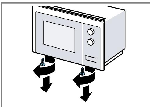
5. Fixați cadrul de montare la baza cuptorului cu microunde cu cele două șuruburi exterioare.
