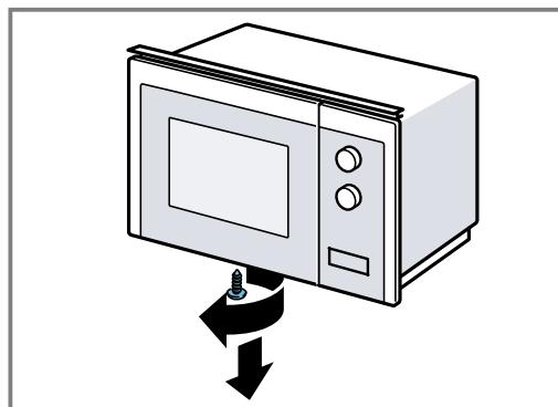
2. Снимите защитную панель со дна микроволновой печи.
