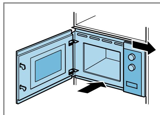
3. Dokręcać urządzenie, aż zostanie wyśrodkowane.
