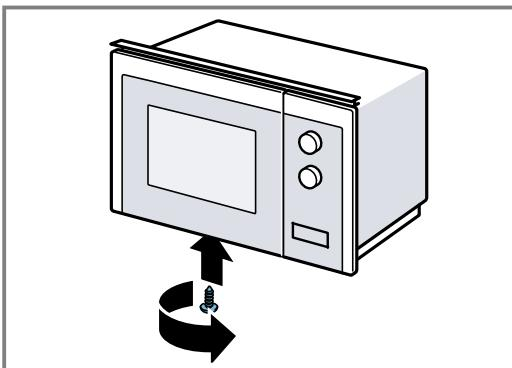
4. Odkręcić 2 zewnętrzne śruby w dnie kuchenki mikrofalowej.
